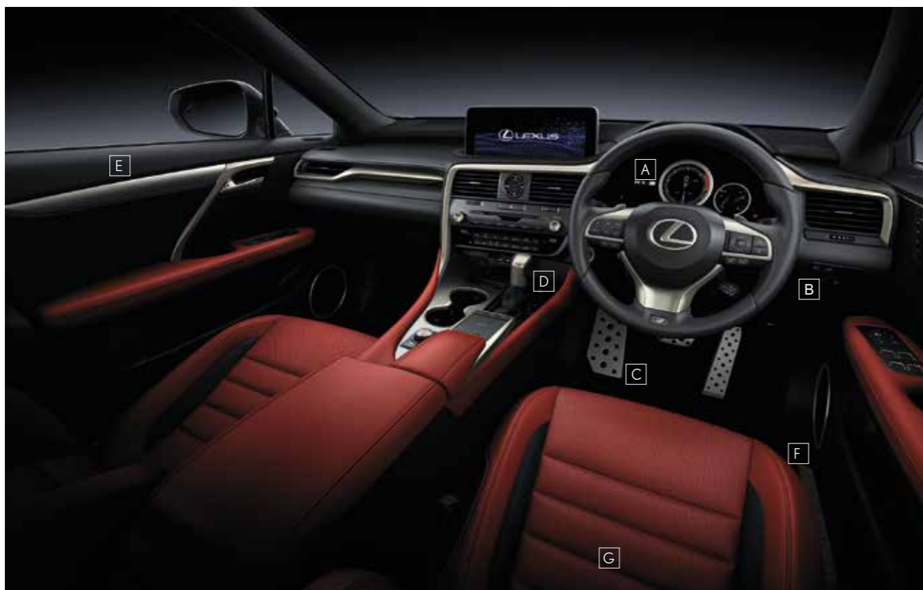
A. Meter & multi-information display B. Steering wheel C. Aluminum pedals D. Shift lever knob E. Trim (Aluminum) F. Scuff plates G. Front Seats A. เมตรวัดและจอ Multi-information B. พวงมาลัย C. แป้นเหยียบอลูมิเนียม D. หัวเกียร์ E. ขอบแผงประตู (อลูมิเนียม) F. สติฟพลาน์ไนด์ประตู G. เบาะหน้า
